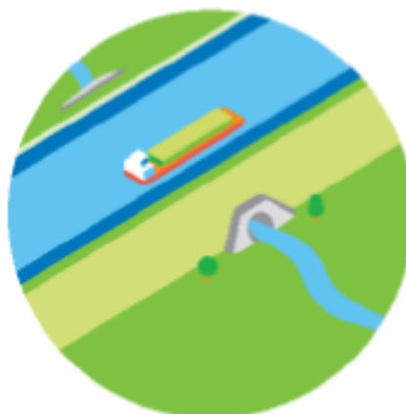
Figure 56 : Schéma de principe d'aqueduc assurant l'écoulement des cours d'eau
